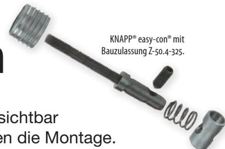
bindungsbeschlag »Easy-Con« von Knapp. Der Verbinder ist zwar in der Anschaffung deutlich teurer als die Lösung mit der Einschraubmutter, benötigt jedoch einen Sacklochdurchmesser von nur 20 mm und erlaubt eine sehr einfache und ergonomische Montage.
