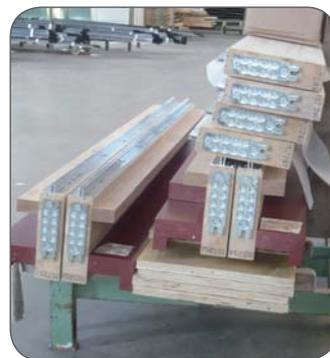
■ Vorgefertigte Pfosten bereit zum Versand.
