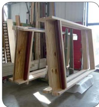
■ Im Werk vorgefertigte Rahmen-elemente.
