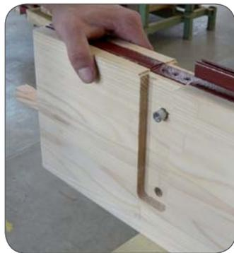
■ Ausfräsung im Pfosten mit Verbundmutter für RICON®-Doppelanschluss.
