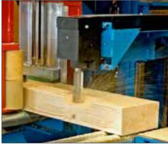
1 Ausfräsung und Vorbohrungen mit der Abbundanlage herstellen.
