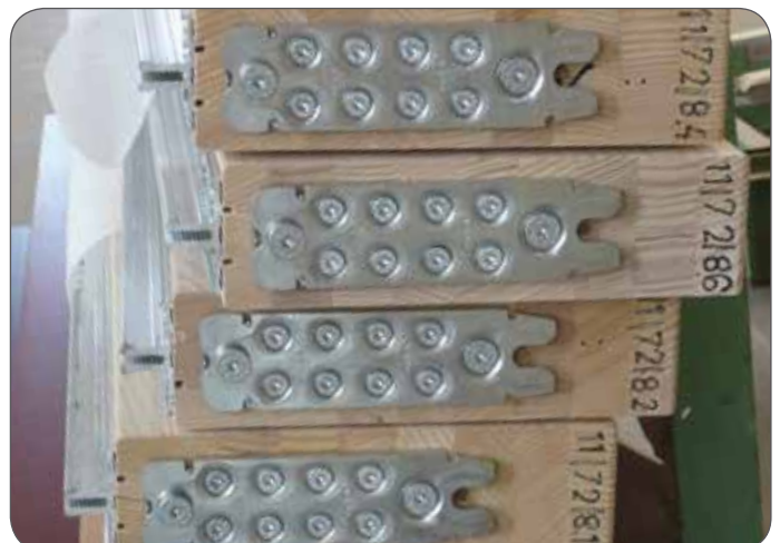
■ BS-Holz-Riegel mit RICON® und Alu-Grundprofilen.
