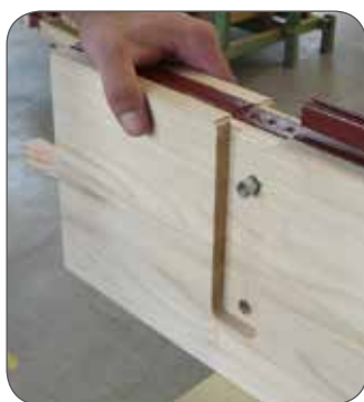
■ Ausfräsung im Pfosten mit Verbundmutter für RICON®-Doppelanschluss.
