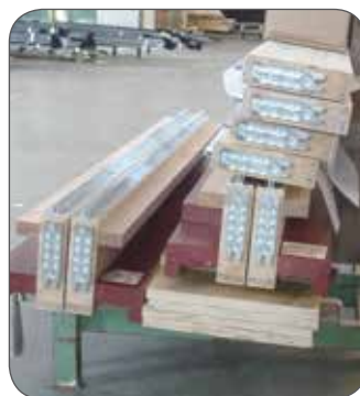
■ Vorgefertigte Pfosten bereit zum Versand.
