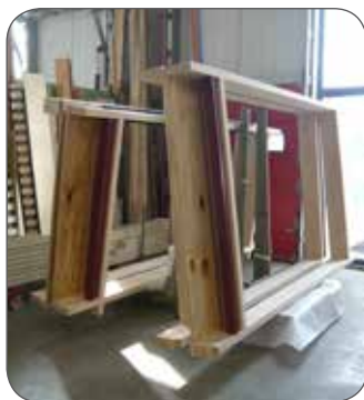
■ Im Werk vorgefertigte Rahmenelemente.
